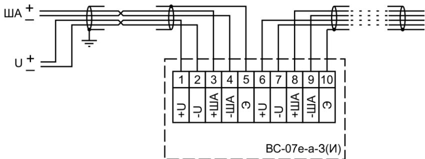
U - внешний развязанный источник питания  $U_{\text{Н}}=24 \text{ В} \pm 10\%$ ; ША - адресная линия связи ППКиУП “Vesta 01F” или модуля сопряжения “MC-5”; Э - экран.
