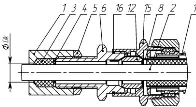
и) монтаж бронированным кабелем в металлокоркаве в кабельном вводе КВМ
